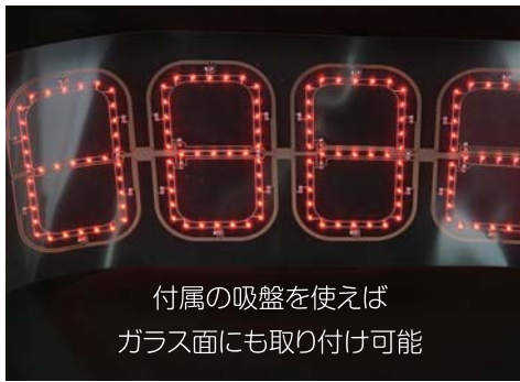
「まるで紙?」ひときわ目立つ! 厚さ0.3mmの電光掲示板
